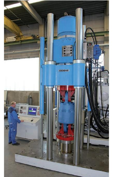
Dynamischer Test bei einem Viskosedämpfer im Testlabor von SCHREIBER
