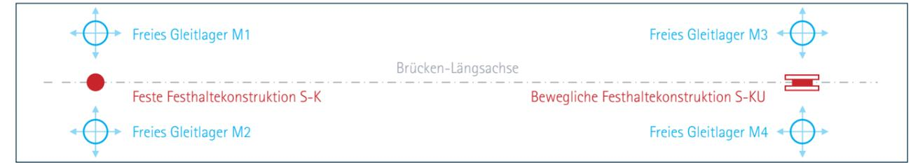
Festhaltekonstruktion - typischer Aufbau mit Bauwerkslagern
