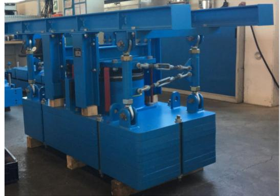
SCHREIBER entwarf, fertigte, testete, lieferte und überwachte die Installation der TMDs, von denen jeder eine bewegliche Masse von 3 Tonnen hat und eine Gesamtdämpfung von 20% ermöglicht.
